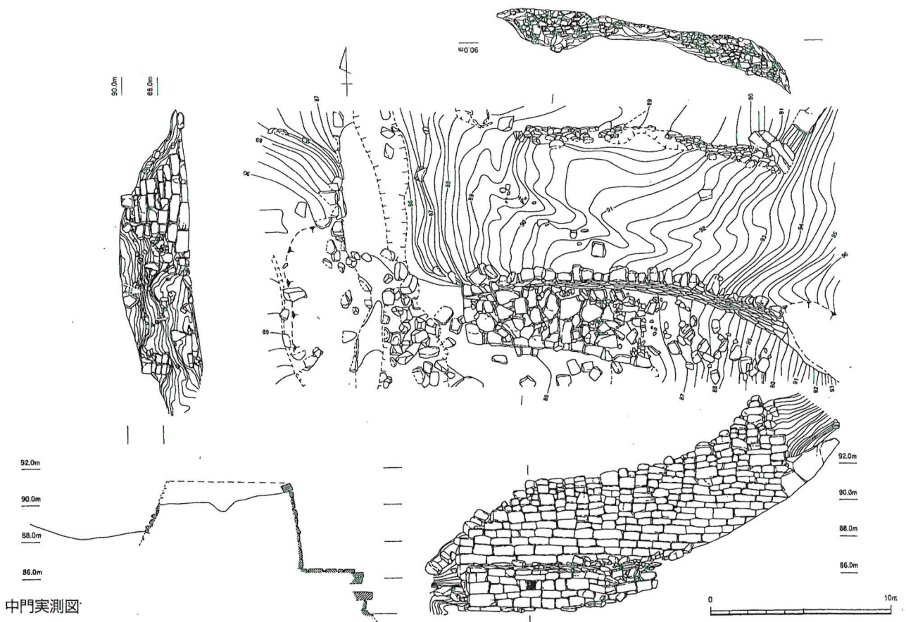
御所ヶ谷神籠石全測・中門実測図 (縮尺 1=1/500、2=1/300)
