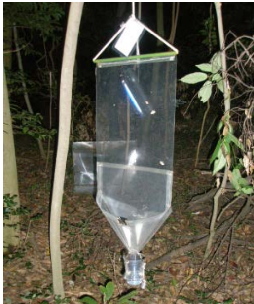
吊り下げ式衝突板トラップに乾電池式 ブラックライトを設置
